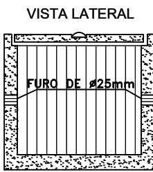
DETALHE CAIXA DE ATERAMENTO SEM ESCALA
